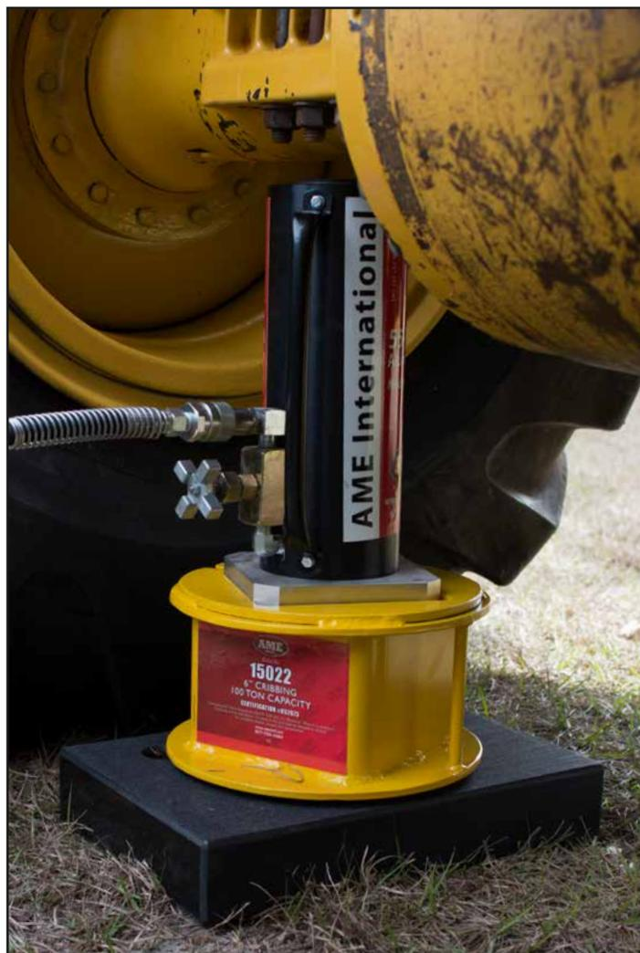
**TRABA CARGA DE MANERA SEGURA PARA MÁXIMA ESTABILIDAD EN TERRENO IRREGULAR**
